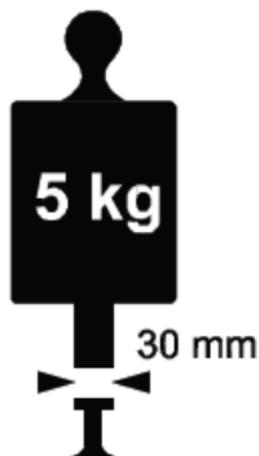
Устройство для измерения толщины одежды и обуви должно иметь цену деления в одну десятую миллиметра (0.1 мм). Измерения должны проводиться с использованием веса в 5.0 кг. Устройство должно иметь два (2) круглых плоских диска, с поверхностью, обращенной друг к другу, каждый диаметром 30 мм.
